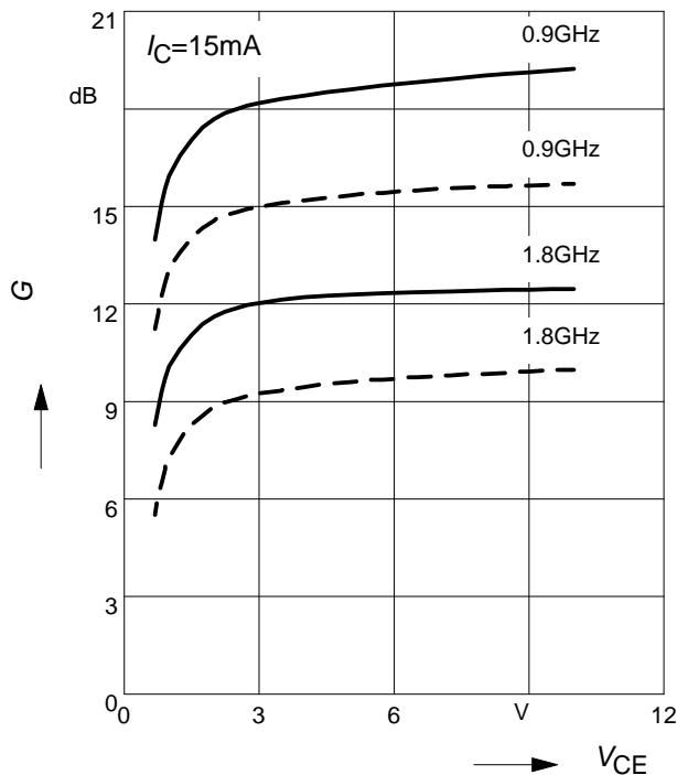
**Power Gain**  $G_{\text{ma}}, G_{\text{ms}} = f(f)$
