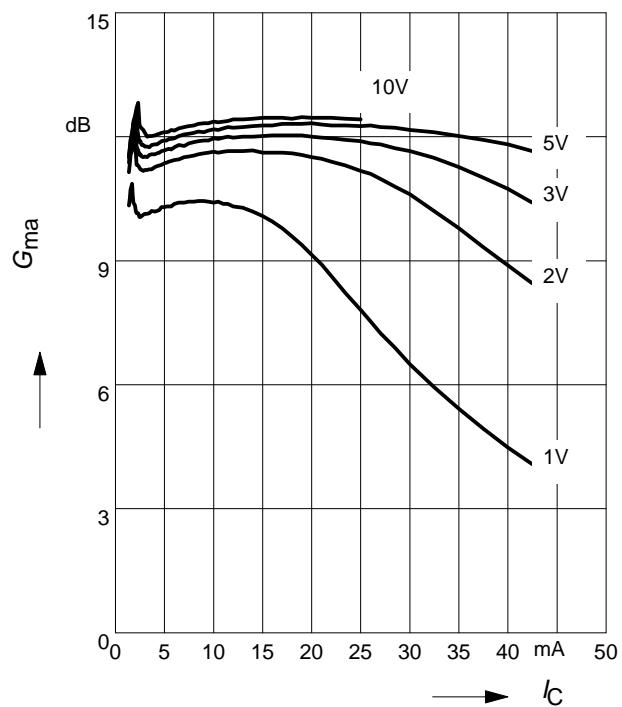
**Power Gain**  $G_{\text{ma}}, G_{\text{ms}} = f(V_{\text{CE}})$ : \_\_\_\_\_
